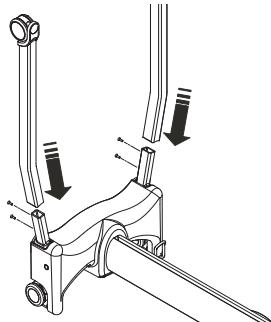
3. Ziehen Sie die auf beiden Seiten des Rahmens befindlichen 6-mm-Schrauben mit Hilfe des mitgelieferten Inbusschlüssels fest.
