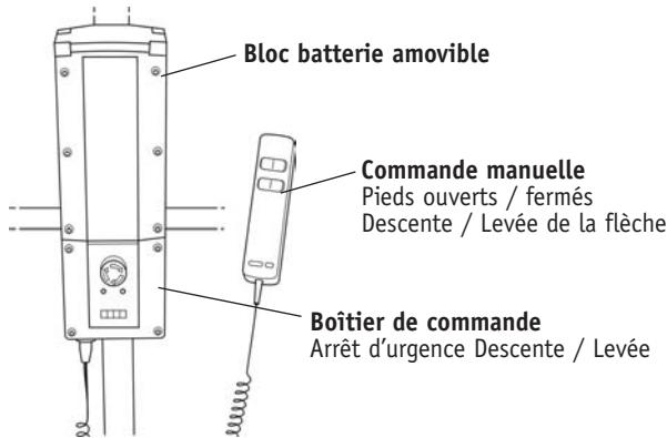
Lorsque le bloc d'alimentation doit être rechargé, retirez-le du lève-personne et branchez-le sur le chargeur autonome.
