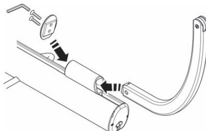
5. Fixez le berceau de positionnement à quatre points sur la flèche de relevage en insérant la goupille fendue. Assurez-vous que la goupille est bien en place.
