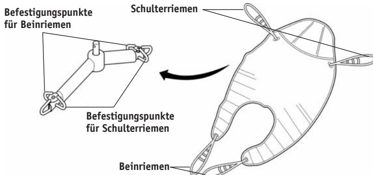
**Sechspunkt-Spreizbügel;** Beispiel für Sechspunkt-Spreizbügelgurt mit Befestigung durch Schleifen
