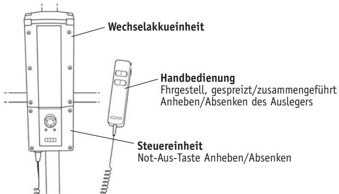
Wenn die Akkueinheit aufgeladen werden muss, wird sie vom Lifter entfernt und an eine externe Ladeeinheit angeschlossen.
