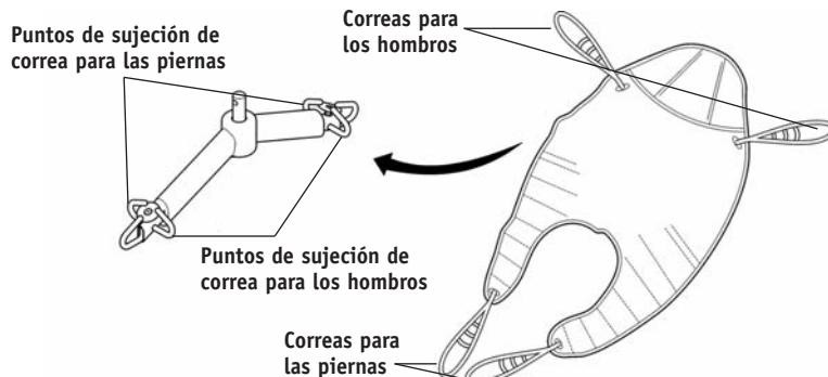
**Barra de extensión de 6 puntos;** ejemplo de la barra de extensión de 6 puntos con sujeteciones de bucle.
