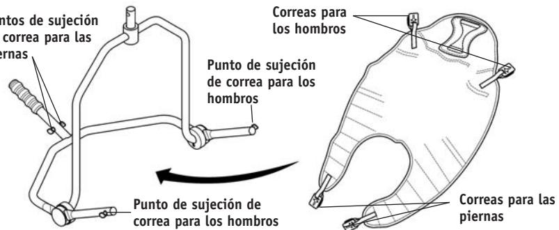
**Percha de 4 puntos;** ejemplo de la eslinga de la percha de 4 puntos con sistema de clip de seguridad.
