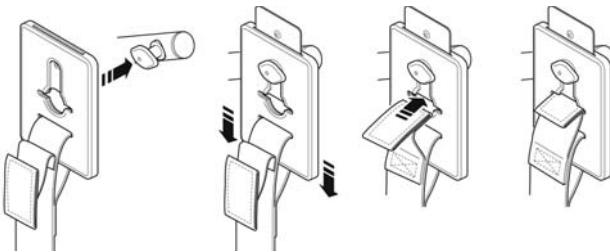
**Système de fixation à sangle Securi3.** Exemple d'installation.
