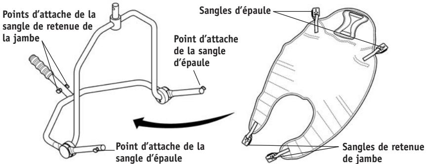
**Châssis à 4 points de fixation** ; Exemple d'une courroie pour châssis à 4 points dotée d'attachments sécuritaires.
