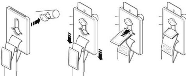
**Sistema de fijación de eslinga Securi3.** Ejemplo de instalación.
