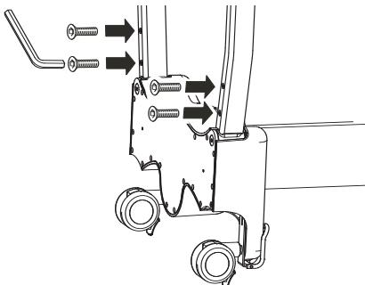
4. Setzen Sie den gekrümmten Auslegerabschnitt in den Auslegerschlitten ein.
